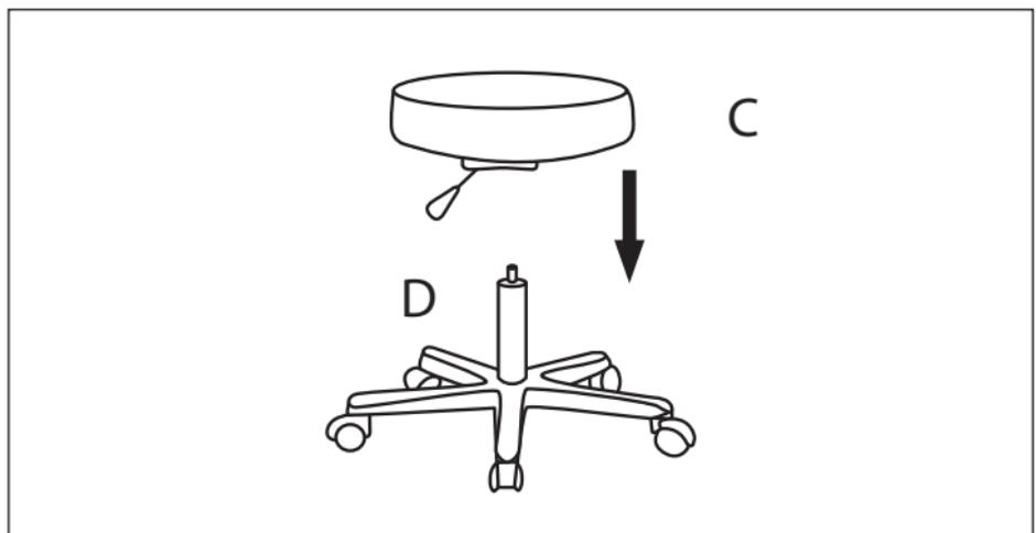
**Étape 2.** Emboîter le siège C sur le vérin à gaz D.
