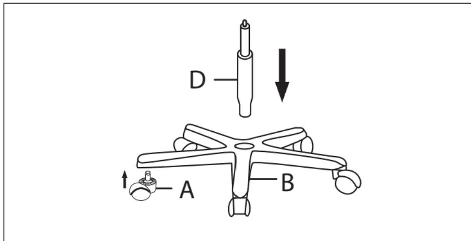
**Étape 1.** Emboîter les roulettes A dans chaque encoche du pied B. Puis, insérer le vérin à gaz D dans le pied B.
